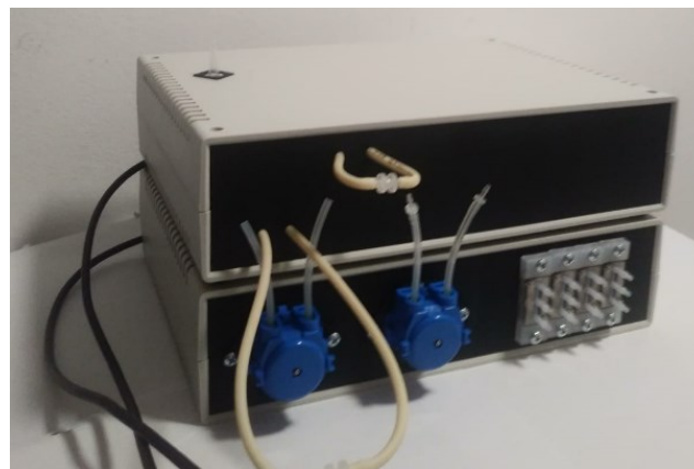
Fig. 6 – Modul de fluidica cu hardware de control si integrare software
