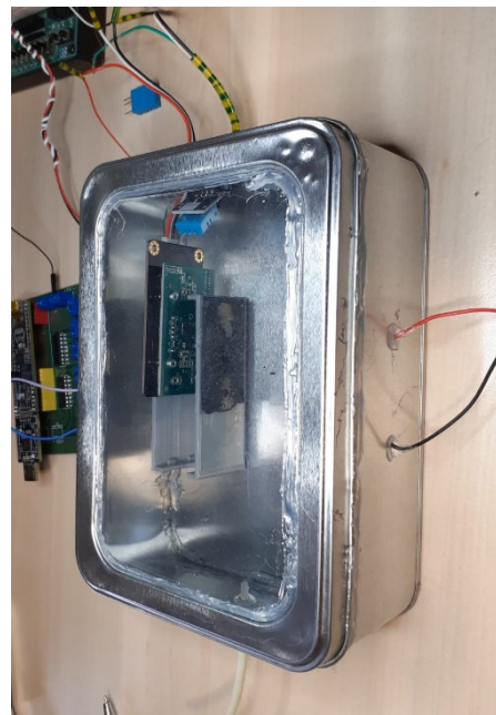
Fig. 8 – Varianta de volum mediu al reactorului pentru gaze cu fereastră optic transparenta
